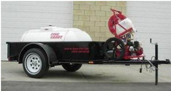
Bomba y manguera de remolque de agua
